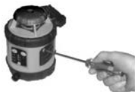
Calibración de la dirección X
